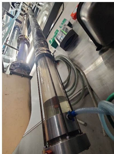
Hiilidioksidin talteenottolaitteisto ja 7 m korkea kolonni
