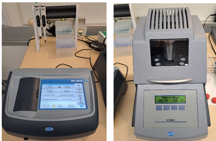
Spectrofotometri DR3900 ja kuivahaude HT200S
