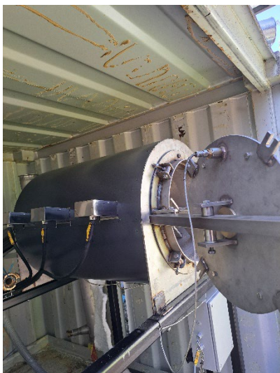
Panostoiminen biohiilen valmistuslaitteisto "hiiletin" sivusta ja sisältä.
