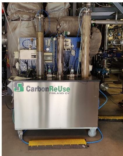
Hiilidioksidin talteenottolaitteisto ja 7 m korkea kolonni
