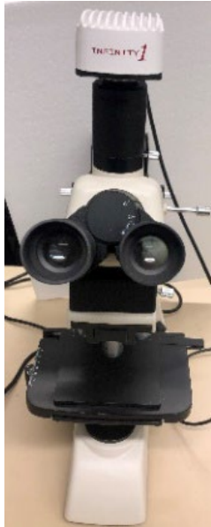
Mitector MJX-materiaalimikroskooppi + kytkettynä Lumenera Infinity mikroskooppikameraan
